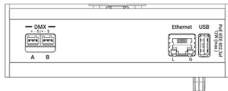
2Port Node DIN-Rail grandMA3 panneau arrière
