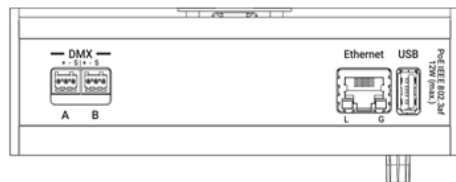
grandMA3 2Port Node DIN-Rail Rückseite
